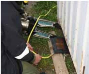
Beim nächsten Einsatzszenario mussten die Männer einen Verletzten befreien, dessen Beine unter einem Baucontainer eingeklemmt waren. Auch hier war vor allem schnelles Arbeiten gefragt. Mit Hilfe des hydraulischen Rettungsgeräts und der pneumatischen Hebekissen konnte der Container schnell angehoben und die Person befreit werden.
